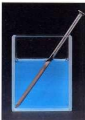
B1 Eisennagel in Kupfer(II)-sulfat-Lösung
